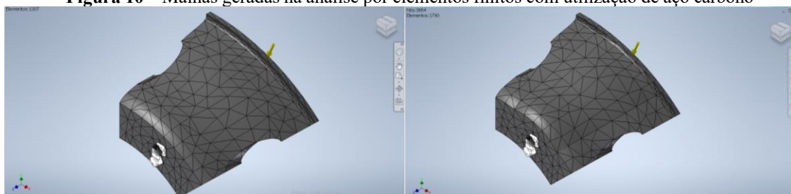
Figura 10 – Malhas geradas na análise por elementos finitos com utilização de aço carbono
