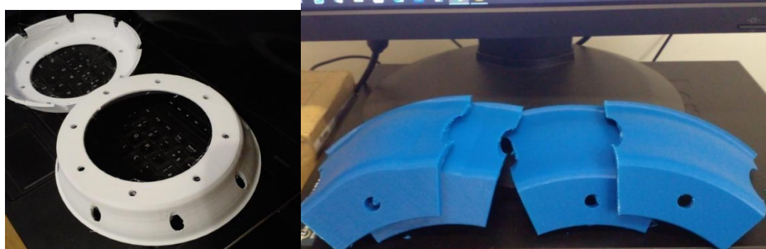
Figura 15 - Protótipos gerados por impressão 3D para análise forma e geometria dos componentes
